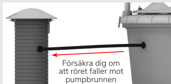
Bild 11: Påfyllnadsröret faller mot pumpbrunnen
