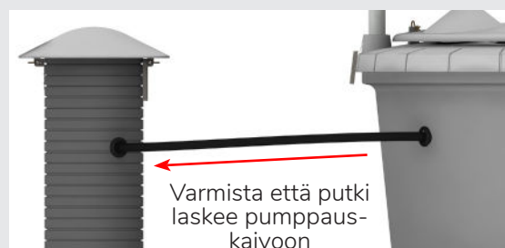
Kuva 12: Täyttöputki laskee pumppauskaivoon
